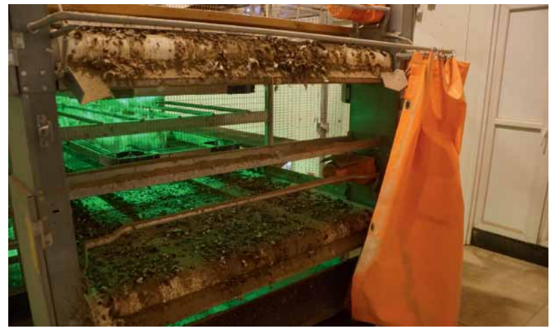
Der Abwurf des getrockneten Kots aus das Quer-Förderband.
