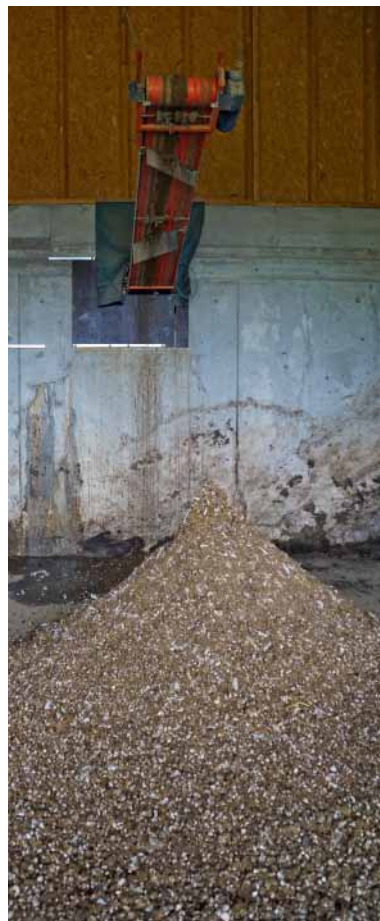
Der Abwurf des getrockneten Kots im Kotbunker.
