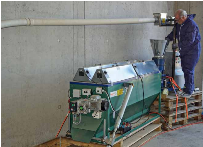
Die Pilotanlage: Förderrohr, Pelletiergerät und Trocknungsmaschine.
